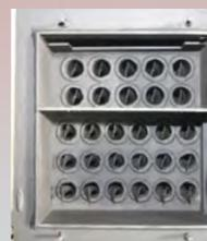
cevni izmenjivač sa mehanizmom za čišćenje
